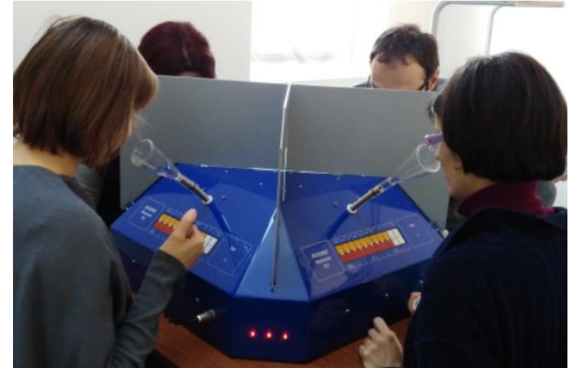
Olfattometro Olfasense GmbH modello TO8 per la determinazione della concentrazione di odore in campioni gassosi in conformità alle prescrizioni della Norma UNI EN 13725:04.
